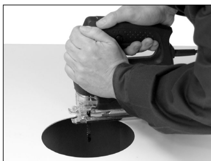
4- Skær et udsugningshul i maskinens topplade.
