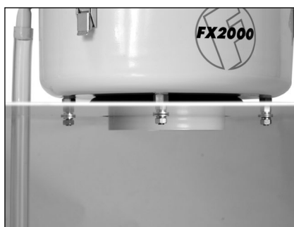
8- Monter og fastgør enheden på maskinen
